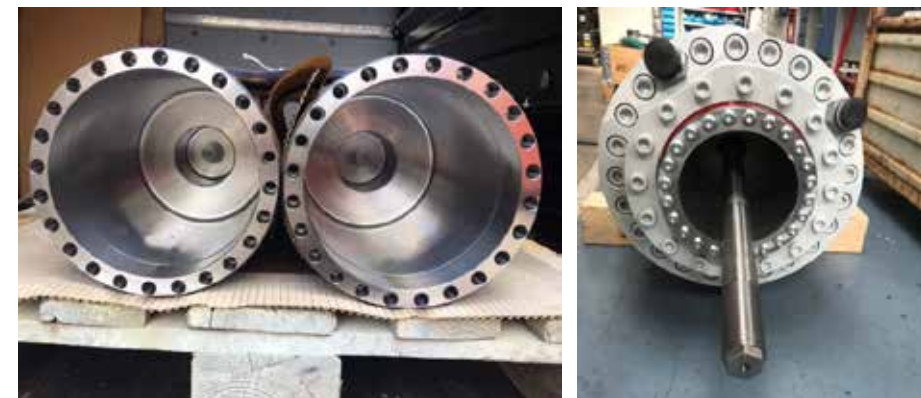
Obr. 2: Úprava uchycení lisovních válců k beranu. Vlevo: úprava pístnic pro vložení binárního členu. Vpravo: kompletní sestava lisovního válce s binárním členem.
